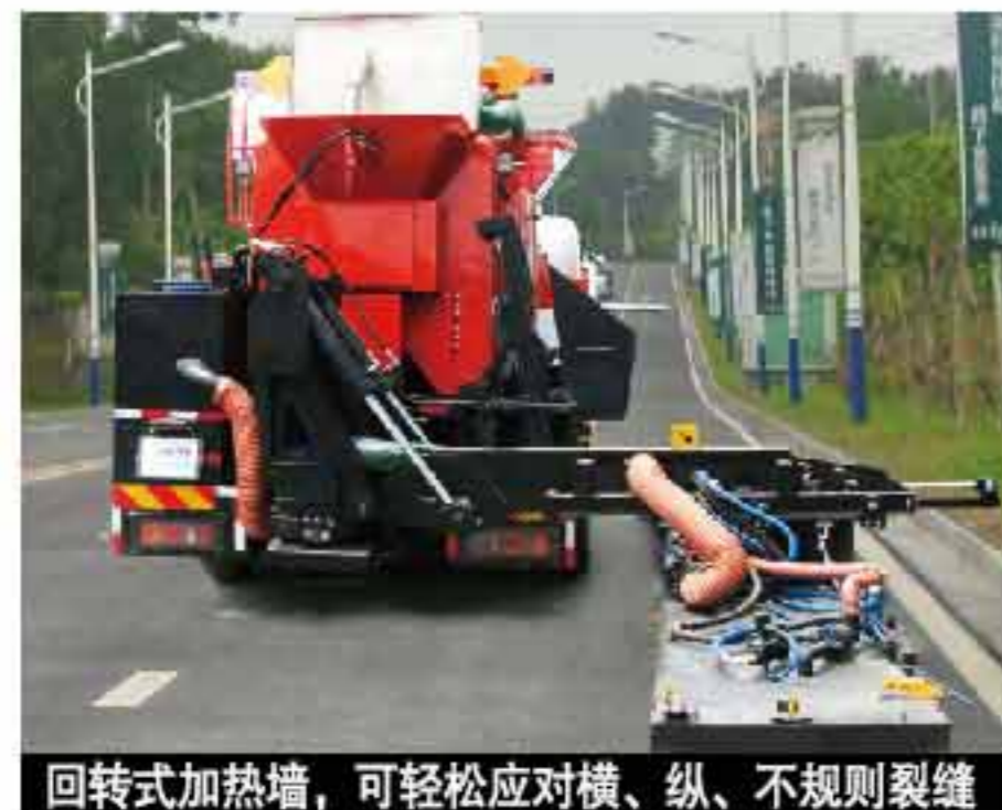
回转式加热墙,可轻松应对纵、横、不规则裂缝
