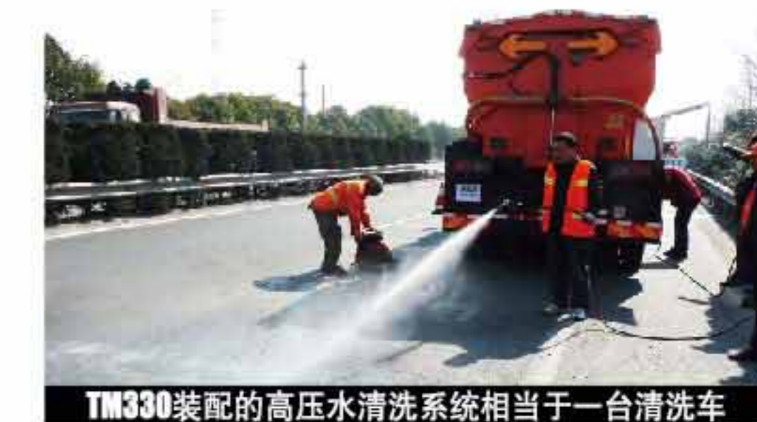
TM330装配的高压水清洗系统相当于一台清洗车
