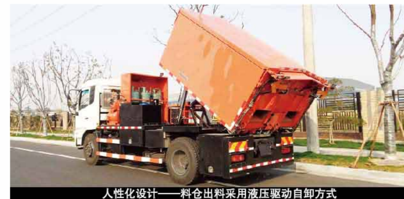
人性化设计——料仓出料采用液压驱动自卸方式
