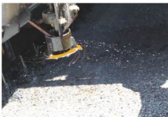
英达专利盘式洒布系统，均匀喷洒再生剂
