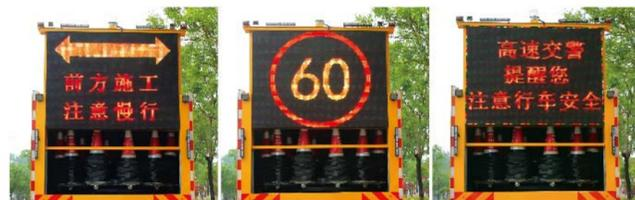
大型LED显示屏，可显示多种交通图形和文字 ▲
